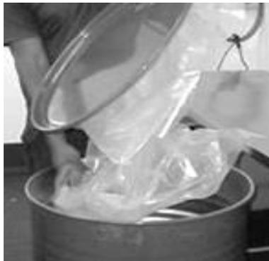
**Figura 40:** Bolsa estéril sendo colocada dentro do tambor. Fonte: Autor.
