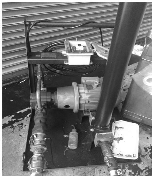
**Figura 32:** Carrinho de filtração PALL. Fonte: Autor.
