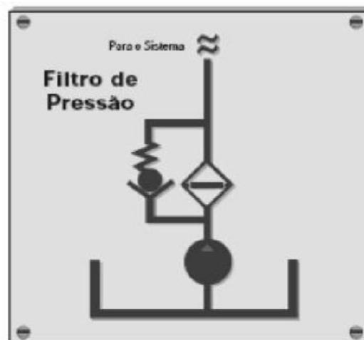
Figura 18: Filtro de pressão. Fonte: HYDAC (2014).
