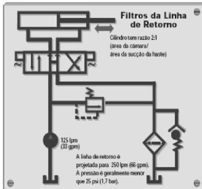
**Figura 19:** Filtro de retorno. Fonte: HYDAC (2014).
