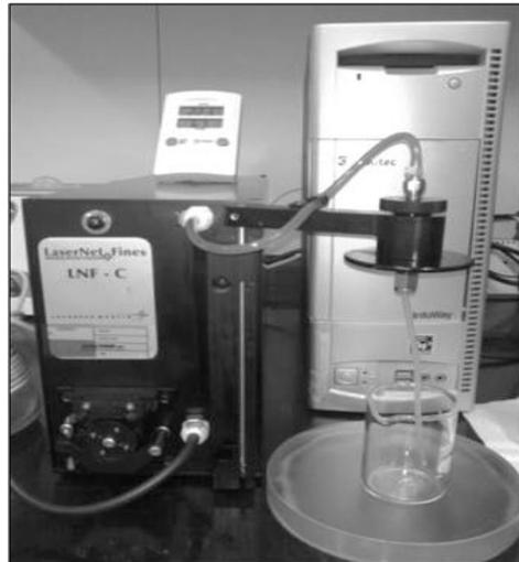
**Figura 33:** Classificador e contador de partículas. Fonte: Autor.**Tabela 12:** Dados técnicos do contador de partículas.
