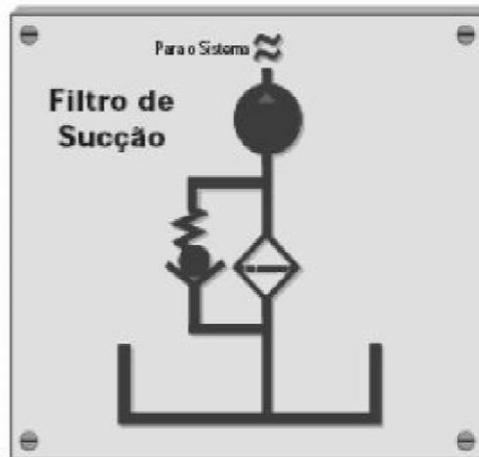
Figura 17: Filtro de sucção. Fonte: HYDAC (2014).
